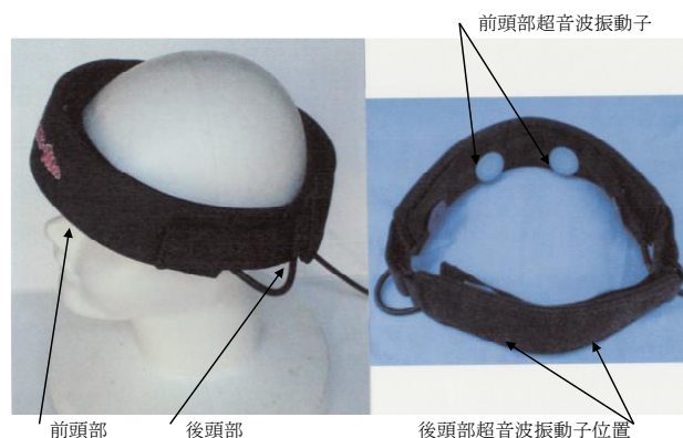
図1 頭部マッサージ器 Mu-Ma Pro 超音波刺激バンドの頭部装着と振動子装着位置
